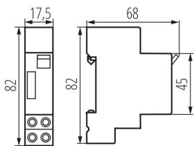
L'automate pour escaliers sert à maintenir l'éclairage pendant le temps indiqué, offre la possibilité de régler le temps dans l'intervalle entre 1 et 7 minutes, la précision de réglage du temps de programme est de 0,5 minutes.
