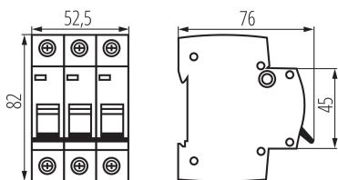
Le disjoncteur avec protection contre les surintensités est utilisé pour la protection des câbles contre les surcharges et les courts-circuits dans les installations et les appareils.
