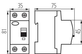
Le disjoncteur différentiel : utilisé comme protection supplémentaire contre les chocs électriques, il est conçu pour fonctionner dans des circuits de courant alternatif sinusoïdal (type AC) et de courant alternatif et pulsatoire sinusoïdal avec une composante constante (type A).
