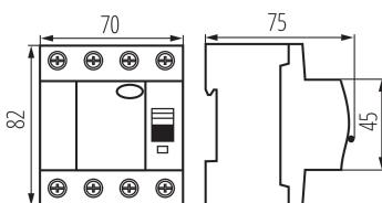
Le disjoncteur différentiel : utilisé comme protection supplémentaire contre les chocs électriques, il est conçu pour fonctionner dans des circuits de courant alternatif sinusoïdal (type AC) et de courant alternatif et pulsatoire sinusoïdal avec une composante constante (type A).
