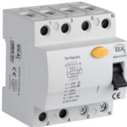
Le disjoncteur différentiel : utilisé comme protection supplémentaire contre les chocs électriques, il est conçu pour fonctionner dans des circuits de courant alternatif sinusoïdal (type AC) et de courant alternatif et pulsatoire sinusoïdal avec une composante constante (type A).
