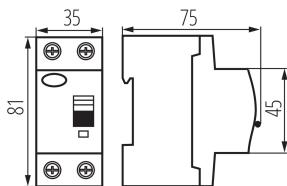
Le disjoncteur différentiel : utilisé comme protection supplémentaire contre les chocs électriques, il est conçu pour fonctionner dans des circuits de courant alternatif sinusoïdal (type AC) et de courant alternatif et pulsatoire sinusoïdal avec une composante constante (type A).
