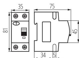
Le disjoncteur différentiel avec protection contre les surintensités est utilisé pour la protection contre les surcharges et les courts-circuits dans les installations et les appareils, ainsi que pour la protection contre les chocs électriques.
