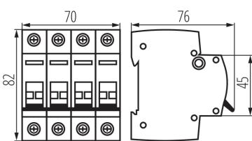
L'interrupteur-sectionneur est utilisé pour déconnecter les circuits chargés de courant nominal.
