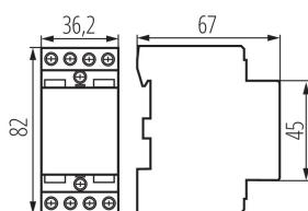
Le contact est utilisé pour allumer automatiquement les appareils consommateurs d'électricité. Catégories d'utilisation AC7a, AC7b.
