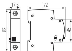
Module de réserve d'espace du commutateur, montage sur rail TH35, largeur de module (17,5mm).
