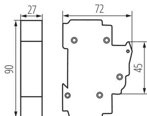
L'interrupteur-sectionneur KSF est un appareil qui permet de remplacer les éléments de remplacement pour la protection des installations électriques par des fusibles de système D02.
