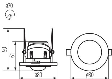
Kanlux MERGE ADJ est un détecteur de mouvement infra-rouge qui détecte sur une portée maximum de 5m. En outre, il détecte sur 360°. Les paramètres de réglage du détecteur MERGE ADJ sont facilement accessibles et ne nécessitent pas de démontage.
