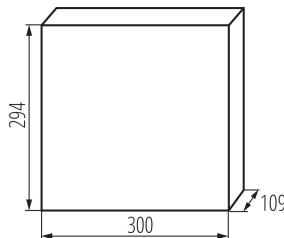
Les appareils de commutation de la série KDB répondant aux exigences de résistance aux braises à 650°C, peuvent être utilisés seulement sur des surfaces incombustibles (par ex. parois solides et pleines, en matériaux incombustibles). Ils ne peuvent pas être utilisés sur des surfaces inflammables (par ex. plaques de plâtre, bois, etc.), sur des parois dites « creuses » ou sur des gaines électriques.
