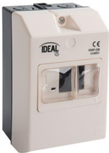
Boîtier pour interrupteurs à moteurs, degré de protection IP65. Le boîtier peut contenir un interrupteur motorisé, un module de 17,5 mm de largeur et un module de 8,75 mm de largeur. Le boîtier est muni de fenêtres transparentes pour l'actionnement des boutons de commande.
