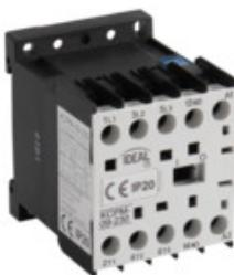
Les contacteurs de puissance miniature sont conçus pour connecter des circuits de courant alternatif de classe d'utilisation AC3. Plage de courant de la série jusqu'à 12A, tension d'alimentation 24VAC ou 230VAC. Les contacteurs sont équipés en standard d'un contact auxiliaire 1NO.
