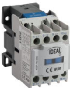
Les contacteurs de puissance sont conçus pour connecter des circuits AC de classe d'utilisation AC3. Plage de courant de la série jusqu'à 32A, tension d'alimentation 24VAC ou 230VAC. Les contacteurs sont équipés en standard d'un contact auxiliaire 1NO.
