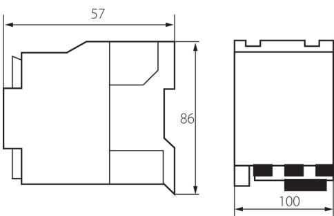
Les contacteurs de puissance sont conçus pour connecter des circuits AC de classe d'utilisation AC3. Plage de courant de la série jusqu'à 32A, tension d'alimentation 24VAC ou 230VAC. Les contacteurs sont équipés en standard d'un contact auxiliaire 1NO.
