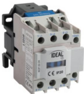
Les contacteurs de puissance sont conçus pour connecter des circuits AC de classe d'utilisation AC3. Plage de courant de la série jusqu'à 32A, tension d'alimentation 24VAC ou 230VAC. Les contacteurs sont équipés en standard d'un contact auxiliaire 1NO.
