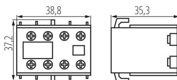
Bloc de contacts auxiliaires pour contacteurs de puissance miniature, doté de quatre contacts - 2NO et 2NC, installation du devant du contacteur.
