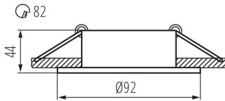
Kanlux IVRI est une gamme d'anneaux de décoration, fabriqués en aluminium. Kanlux IVRI est expressif dans ses formes, il permet également de régler la direction de la lumière dans une gamme de 30 degrés.
