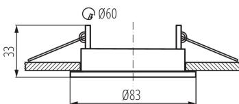
Kanlux ALOR est une gamme riche en couleurs de points LED les plus demandés, d'un diamètre de 8,3 cm. Les points LED ne sont pas dotés de support en céramique. Il est possible de les utiliser avec des boîtiers compatibles avec les culots GU10 ou Gx5,3, ce qui permettra d'installer des sources lumineuses adaptées au projet.
