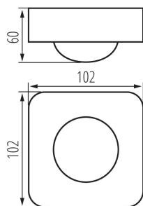
Kanlux SENTO est un capteur électronique pour la détection de mouvement. Sa particularité réside dans le fait que jusqu'à trois détecteurs infrarouges sont installés dans un seul détecteur. Ceci garantit une sensibilité sans précédent et vous permet de capturer le moindre mouvement. Kanlux SENTO, en raison de ses caractéristiques inhabituelles, est appelé détecteur de présence.
