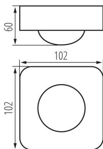
Kanlux SENZO est un détecteur de mouvement PIR utilisé dans les systèmes de commutation d'éclairage automatique. La disposition spéciale de deux capteurs infrarouges à Kanlux SENZO permet de l'utiliser dans des installations en hauteur, telles que des entrepôts ou des halls de production. Sa portée verticale peut atteindre 10 mètres.
