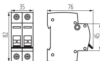
L'interrupteur-sectionneur est utilisé pour déconnecter les circuits chargés de courant nominal.
