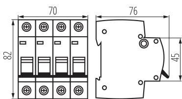
Le disjoncteur avec protection contre les surintensités est utilisé pour la protection des câbles contre les surcharges et les courts-circuits dans les installations et les appareils.
