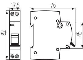
Le disjoncteur avec protection contre les surintensités est utilisé pour la protection des câbles contre les surcharges et les courts-circuits dans les installations et les appareils.
