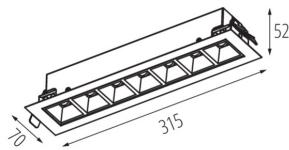
**UGR: <18****PARAMÈTRES POUR LES SOURCES LUMINEUSES LED ET OLED:****Température de couleur proximale [K]: 3000****Constance des couleurs dans les ellipses de MacAdam:  $\leq 6$** **Indice de rendu des couleurs: 80****DONNÉES LOGISTIQUES:****Unité de mesure:** unité**Unité par emballage:** 1**Unité par carton:** 1**Conditionnement:** 1**Poids unitaire net [g]:** 600**Poids [g]:** 840**Poids carton [kg]:** 0.84
