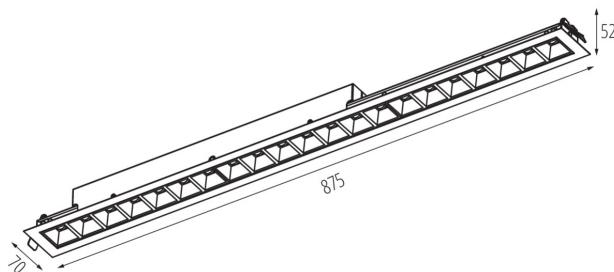
**UGR: <15****PARAMÈTRES POUR LES SOURCES LUMINEUSES LED ET OLED:****Température de couleur proximale [K]: 3000****Constance des couleurs dans les ellipses de MacAdam: ≤6****Indice de rendu des couleurs: 80****DONNÉES LOGISTIQUES:****Unité de mesure:** unité**Unité par emballage:** 1**Unité par carton:** 1**Conditionnement :** 1**Poids unitaire net [g]:** 1230**Poids [g]:** 1570**Poids carton [kg]:** 1.57
