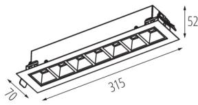
**PARAMÈTRES POUR LES SOURCES LUMINEUSES LED ET OLED:****Température de couleur proximale [K]:** 3500**Constance des couleurs dans les ellipses de MacAdam:** ≤6**Indice de rendu des couleurs:** 80**DONNÉES LOGISTIQUES:****Unité de mesure:** unité**Unité par emballage:** 1**Unité par carton:** 1**Conditionnement :** 1**Poids unitaire net [g]:** 600**Poids [g]:** 840**Poids carton [kg]:** 0.84
