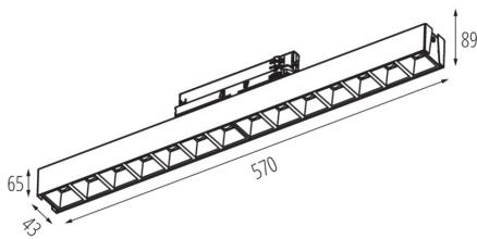
**PARAMÈTRES POUR LES SOURCES LUMINEUSES LED ET OLED:****Température de couleur proximale [K]: 3500****Constance des couleurs dans les ellipses de MacAdam: ≤6****Indice de rendu des couleurs: 80****DONNÉES LOGISTIQUES:****Unité de mesure:** unité**Unité par emballage:** 1**Unité par carton:** 1**Conditionnement :** 1**Poids unitaire net [g]:** 820**Poids [g]:** 1040**Poids carton [kg]:** 1.04
