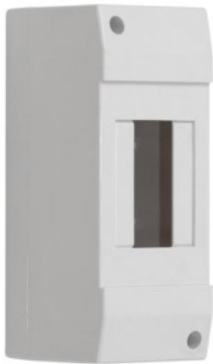
Les appareils de commutation de la série DB, répondant aux exigences de résistance aux braises à 650°C, peuvent être utilisés seulement sur des surfaces incombustibles (par ex. parois solides et pleines, en matériaux incombustibles). Ils ne peuvent pas être utilisés sur des surfaces inflammables (par ex. plaques de plâtre, bois, etc.), sur des parois dites « creuses » ou sur des gaines électriques.
