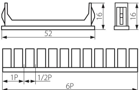
L'obturateur des commutateurs sert à boucher les espaces non utilisés des rails. L'ensemble contient deux obturateurs de taille 1P (17,5 mm) et huit obturateurs de taille 0,5P (8,75mm).
