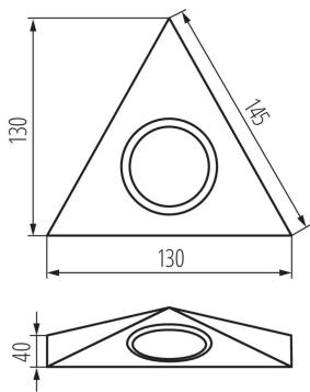
La gamme Kanlux ZEPO sont des spots encastrables pour les étagères, par exemple pour éclairer le plan de travail dans la cuisine. ZEPO sont disponibles dans la version avec et sans interrupteur. Les luminaires nécessitent l'utilisation d'un bloc d'alimentation, par exemple de la série SET. La source lumineuse est destinée pour les points lumineux JC avec culot G4.
