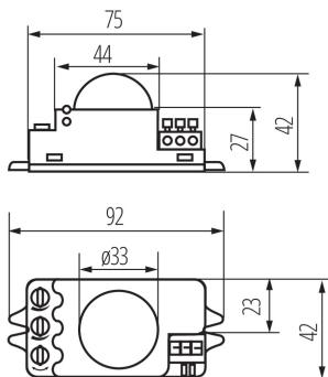
Kanlux ROLF JQ est un capteur de mouvement à micro-ondes. L'angle horizontal maximal de fonctionnement du capteur est de 360 degrés. Il est possible de régler le temps d'éclairage ainsi que le niveau d'intensité lumineuse avec laquelle le capteur fonctionne.
