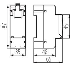
Il timer è progettato per attivare e disattivare l'illuminazione o altri apparecchi elettrici in modalità 24 ore. Il timer è dotato di 8 punti temporali programmabili di attivazione (ON) e disattivazione (OFF). Il programmatore è provvisto di funzione di time shift ON/OFF in base alle variazioni astronomiche giornaliere dell'ora di alba e tramonto.
