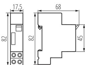
Il temporizzatore della luce delle scale serve per mantenere l'illuminazione per un tempo impostato, il è tempo regolabile da 1min fino a 7min, la precisione dell'impostazione del tempo di programmazione è di 0,5 min.
