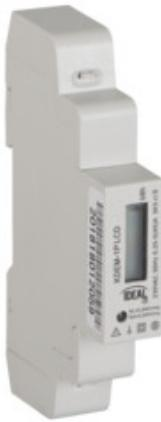
KDEM-1P LCD è un dispositivo utilizzato per monitorare i consumi elettrici di una rete monofase, in applicazioni commerciali e industriali. Misura e visualizza il consumo di energia attiva (kWh). Lo strumento utilizza il metodo di misurazione diretta 5A(45A). KDEM-1P LCD è un contatore conforme con la direttiva MID (classe di precisione B).
