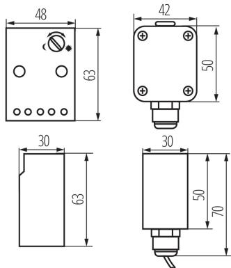
Kanlux AZ-10A è un interruttore crepuscolare. È progettato per attivare e disattivare i circuiti di illuminazione o di altri apparecchi elettrici a seconda del livello di luce naturale (giorno/notte).
