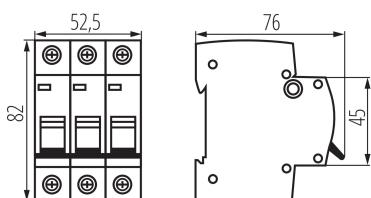
Interruttore automatico magnetotermico: utilizzato per la protezione da sovraccarichi e cortocircuiti.
