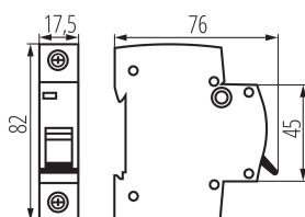
Interruttore automatico magnetotermico: utilizzato per la protezione da sovraccarichi e cortocircuiti Conforme alle norme EN60898-1.
