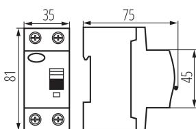
L'interruttore differenziale: viene utilizzato per una protezione aggiuntiva contro le scosse elettriche, progettato per funzionare in circuiti
