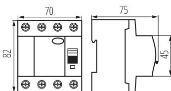
L'interruttore differenziale: viene utilizzato per una protezione aggiuntiva contro le scosse elettriche, progettato per funzionare in circuiti AC sinusoidali e circuiti di tipo A sinusoidali in corrente alternata e pulsante con componente diretta. Conformità a: EN61008-1
