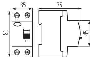
L'interruttore differenziale: viene utilizzato per una protezione aggiuntiva contro le scosse elettriche, progettato per funzionare in circuiti AC sinusoidali e circuiti di tipo A sinusoidali in corrente alternata e pulsante con componente diretta. Conformità a: EN61008-1
