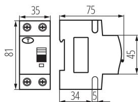
L'interruttore magnetotermico differenziale ha la funzione di interrompere il flusso di energia quando avviene un contatto diretto o indiretto e si verifica una dispersione di corrente, oppure quando si presenta un sovraccarico. Conformità a: EN 61009 -1. Potere di interruzione nominale: 6kA secondo EN60898-1.
