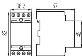
Il contattore viene utilizzato per l'accensione automatica delle utenze elettriche. Categorie d'uso AC7a, AC7b.
