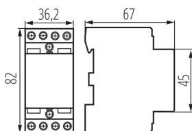
Il contattore viene utilizzato per l'accensione automatica delle utenze elettriche. Categorie d'uso AC7a, AC7b.
