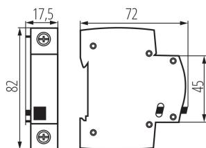
Il modulo di riserva per quadri elettrici, montaggio a binario TH35, larghezza del singolo modulo (17,5mm).
