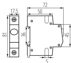
La spia luminosa a LED viene utilizzata per indicare lo stato dei circuiti elettrici.
