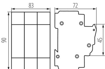
L'interruttore di manovra - sezionatore con il fusibile KSF è un apparecchio che consente di cambiare l'elemento fusibile che protegge gli impianti elettrici in fusibili di sistema D02
