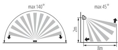
ALER MINI-W è un piccolo sensore a infrarossi dall'aspetto d'effetto e minimalista. Il sensore funziona con l'angolo orizzontale di 140° e con quello verticale di 45°, e grazie alla facile regolazione meccanica (in verticale 45°, in orizzontale 90°) è possibile adattarlo alle proprie esigenze. È dotato dell'elevato grado di protezione (IP44) che lo rende adatto all'installazione in luoghi direttamente esposti agli agenti atmosferici.
